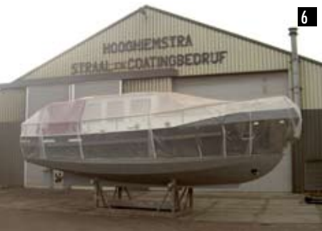
5 Gedeeltelijk gestraald (centimeter voor centimeter worden oude verflagen verwijderd). 6 Gestraald en in de primer. 7 Een boot wordt gestraald bij Hooghiemstra in Uitwellingerga.
