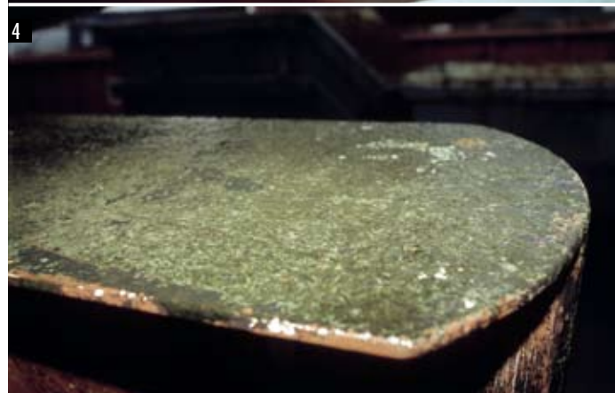
1 Straalbedrijf Hooghiemstra vanaf het Prinses Margrietkanaal. 2 De Elixier wordt uit het water getild. 3 Blaasjes op de romp. 4 'Osmose' op het bovenblad van het roer.
