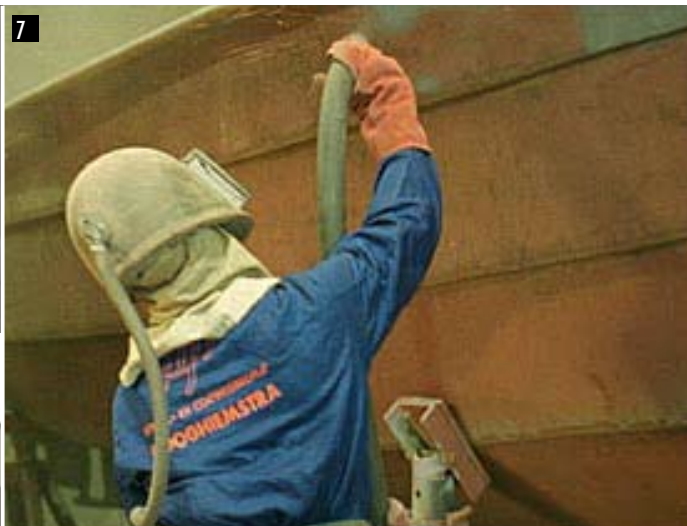
5 Gedeeltelijk gestraald (centimeter voor centimeter worden oude verflagen verwijderd). 6 Gestraald en in de primer. 7 Een boot wordt gestraald bij Hooghiemstra in Uitwellingerga.
