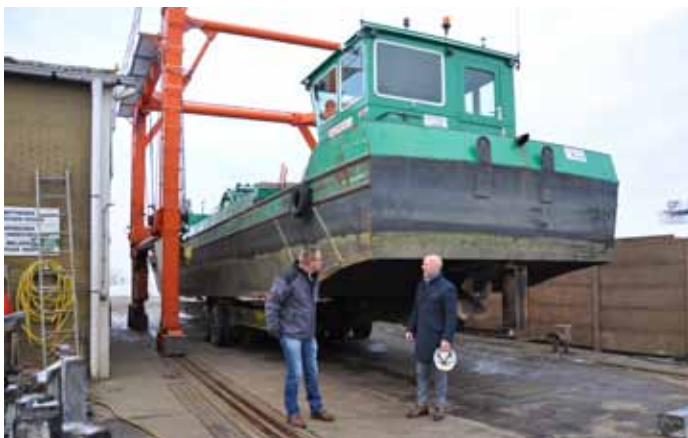
Het kraanschip is in anderhalve week tijd gestraald en voorzien van een nieuw verfsysteem
