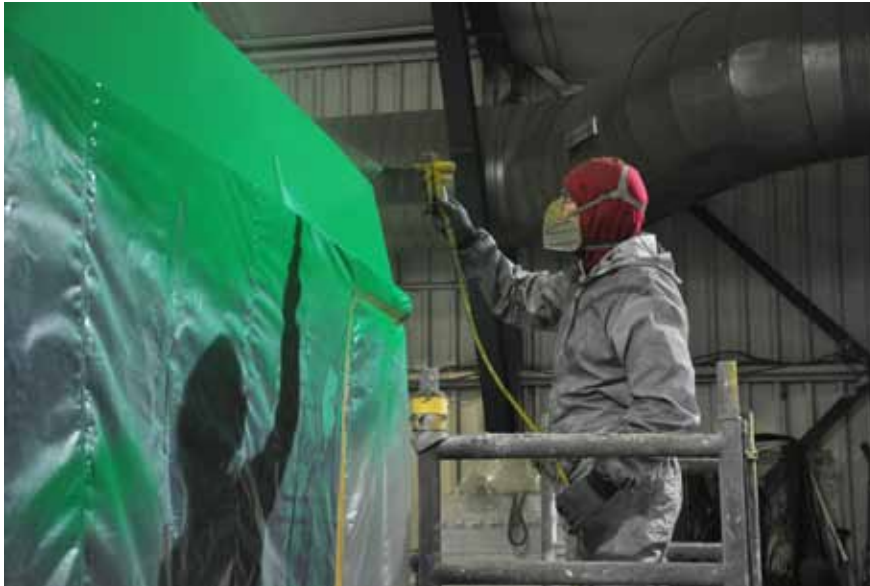
Tenslotte wordt het schip afgelakt met een derde laag coating in de eindkleur Ral 6024
