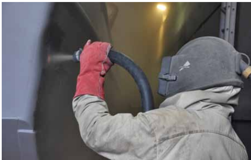
In de straalcabine wordt het onderwaterschip en de romp gestraald met ‘corund’, kleine korreltjes van een hard mineraal
