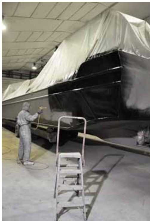
Na het stralen en een eerste laag primer wordt het afgeplakte schip hier voorzien van een tweede laag coating
